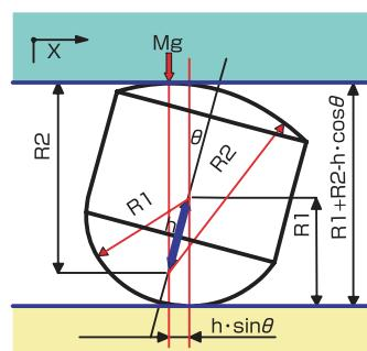
利用曲面力矩的恢复力原理，在很小的空间使振子产生振动。从而以数cm的高度来得到0.5~2Hz的固有振动频率。
