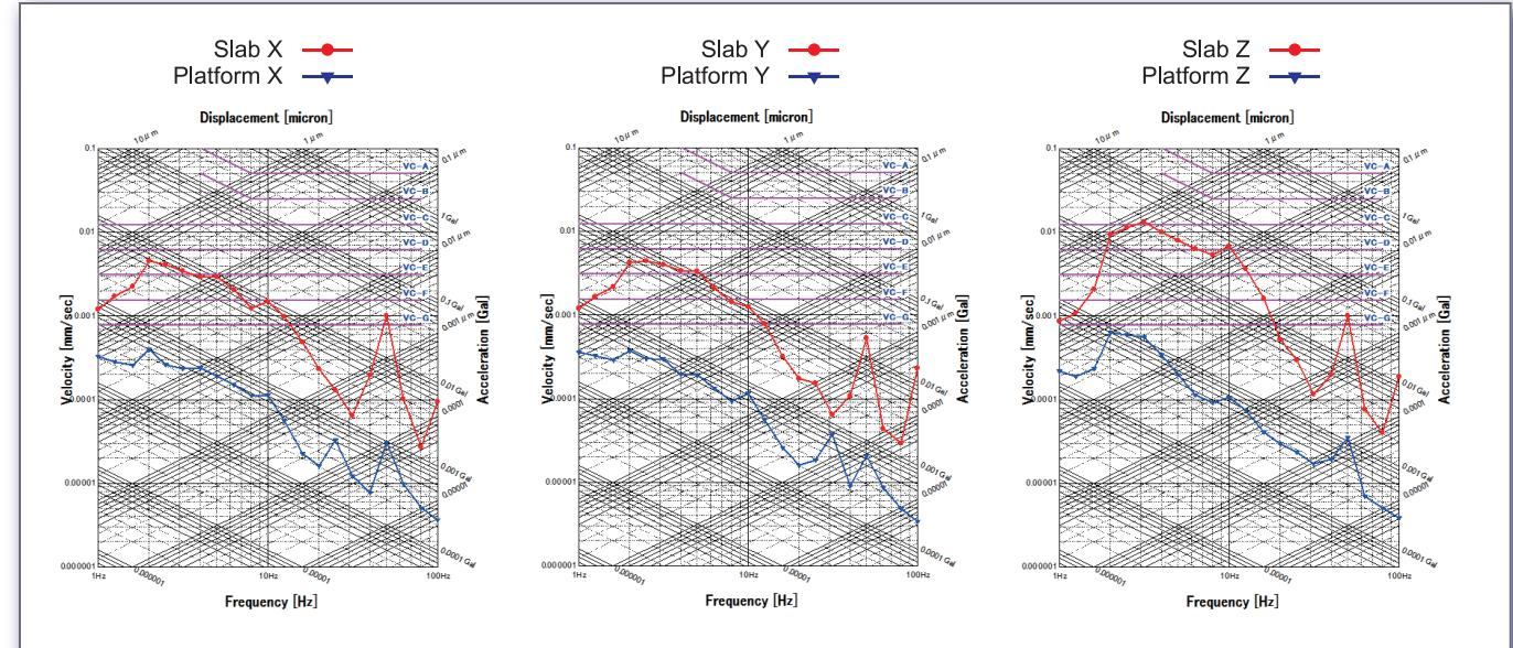
设置场地 (2Hz-3Hz) 振动较大。安装本隔振平台后，全频域内振动值，大幅降低 (VC-D→VC-G) 对电子显微镜图像影响最为严重的低频振动。
