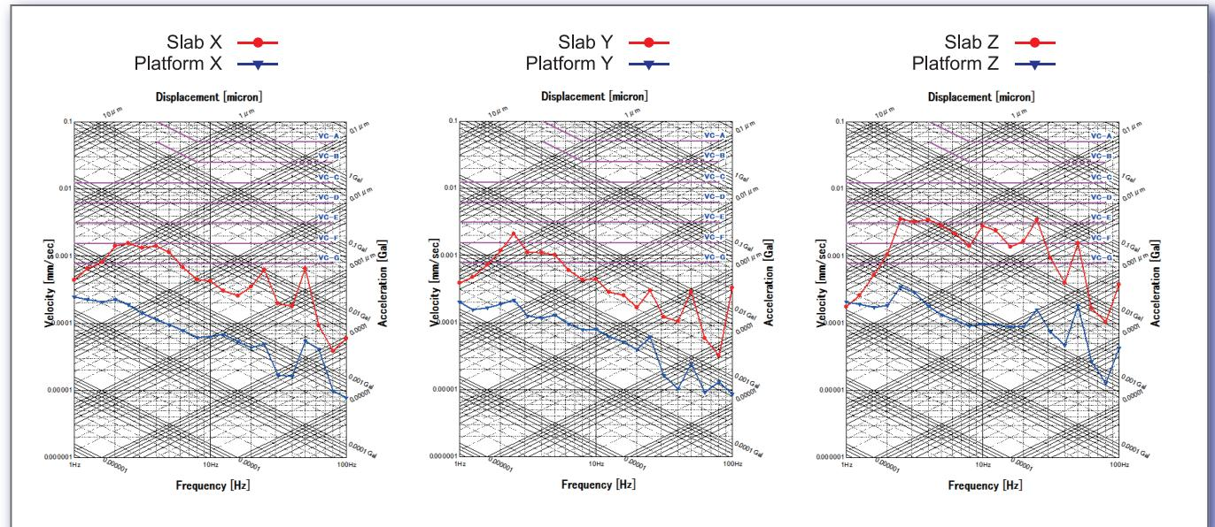
此场地水平X, Y方向振动很小，处在VC-F水平，应用了隔振台后降低到VC-G以下。
