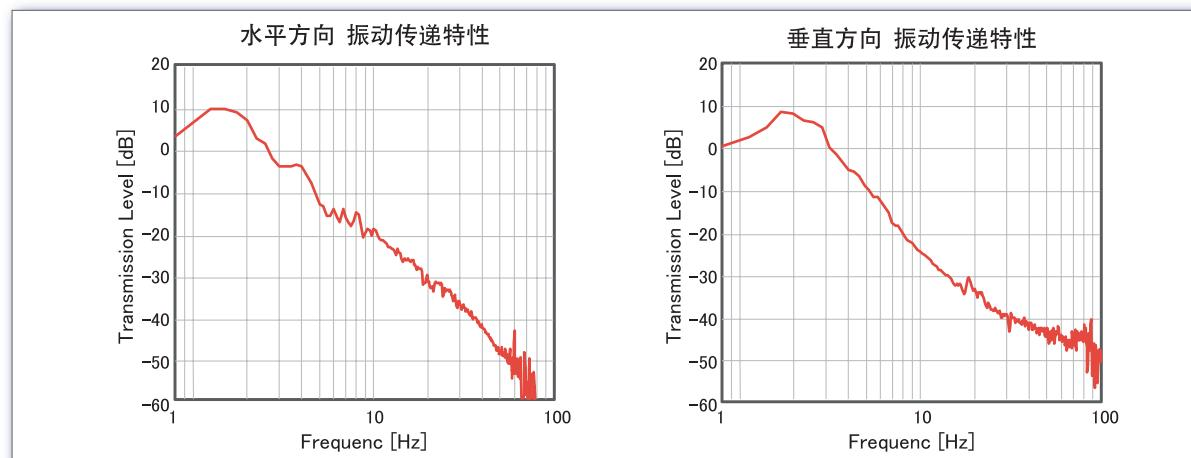
地面振动和隔振台上振动同时测量时的振动传递函数。
