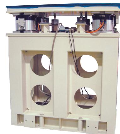
主动式α系列的隔振单元与高刚性架台(FOP)相组合而形成的主动式隔振基座，由于高刚性架台的固有振动频率可设定得很高，能降低低频区的振动响应。
